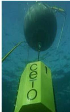
**Gambar 5.14** Pembangkit Listrik Tenaga Gelombang *Renewable Energi Holdings*
