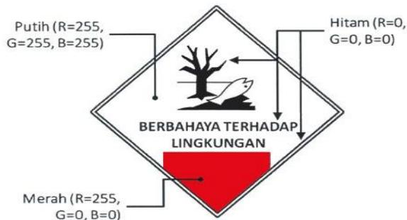
Dasar simbol limbah B3 berwarna putih dengan garis pembentuk belah ketupat bagian dalam berwarna hitam, memuat gambar berupa pohon berwarna hitam, gambar ikan berwarna putih dan gambar tumpahan limbah B3 berwarna hitam yang terletak di sebelah garis belah ketupat bagian dalam. Pada bagian tengah bawah terdapat tulisan BERBAHAYA TERHADAP LINGKUNGAN berwarna hitam serta blok segilima berwarna merah.
