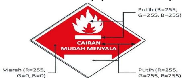
Dasar simbol limbah B3 berwarna merah, memuat gambar berupa lidah api berwarna putih yang menyala pada suatu permukaan berwarna putih terletak di bawah sudut atas garis ketupat bagian dalam. Pada bagian tengah terdapat tulisan CAIRAN MUDAH MENYALA berwarna putih. Blok segilima berwarna putih.
