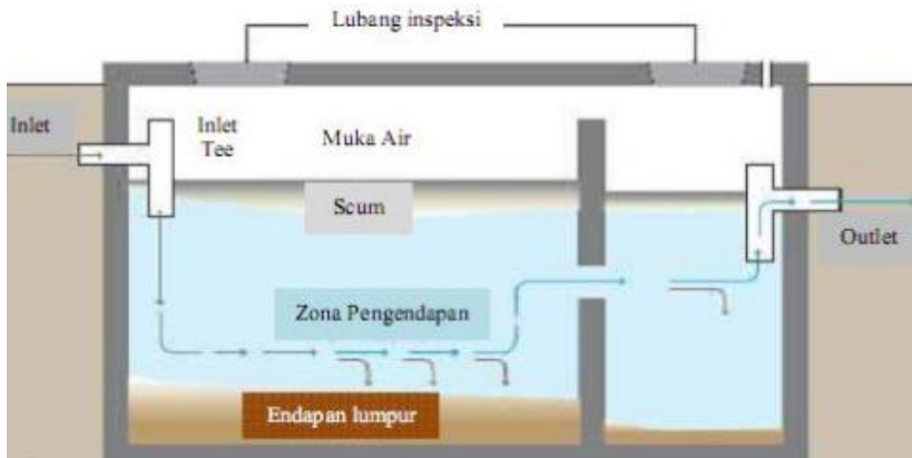
Gambar 4.3 Zona Zona Pada Septik Tank
