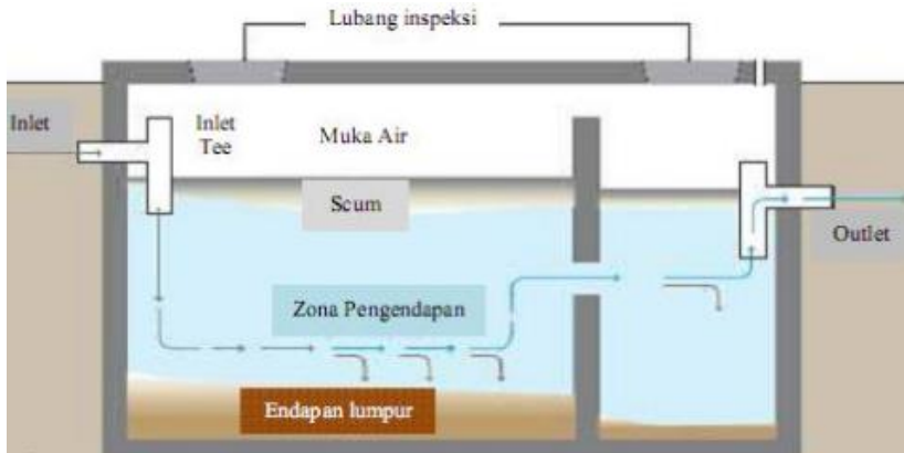
Gambar 4.3 Zona Zona Pada Septic Tank
